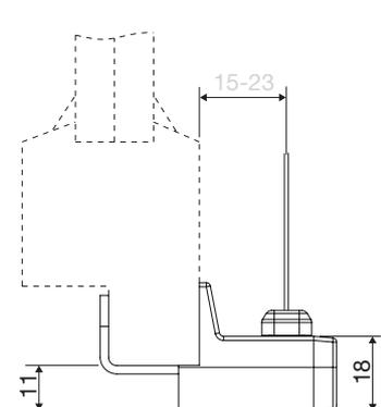
Eine gute Belüftung muss vorhanden sein. Dafür sind sowohl ein Mindestabstand zur Verglasung als auch Lüftungsschlitze oben und unten Voraussetzung.
