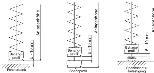
**Hinweis:** Ein Aufliegen des unteren Behangprofils ist funktionsbedingt zu verhindern. Daher ist ein Mindestabstand von 5-10 mm (zur Spannschnurbefestigung, zum Spannprofil bzw. zur Fensterbank) erforderlich.
