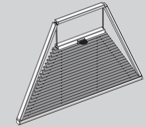
P1435 - Gespannte Anlage mit Bediengriff und beidseitig schrägem Behang
