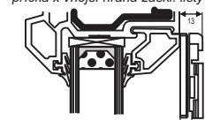
Dvojitě zasklení + příčka 1 ks distančních podložek min. 15 mm rozdíl příčka x vnější hrana zaskl. lišty
